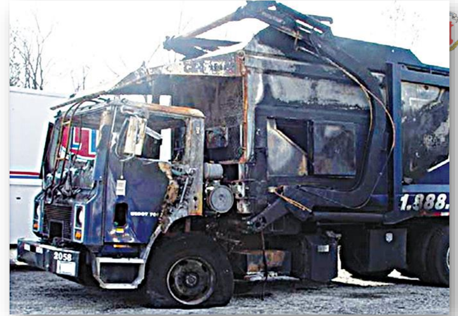
FIGURA 13.3.5.2 No solo el peligro biológico debería ser una preocupación, este vehículo debería ser bloqueado para evitar el funcionamiento de los sistemas hidráulicos.
